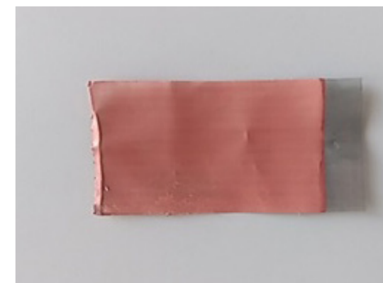
Наночастица оксида меди, осаждённая на стальную сеточку
