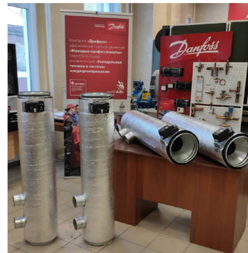
Макет узла регулирования комплексной адаптивной системы распределенного регулирования микроклимата помещений
